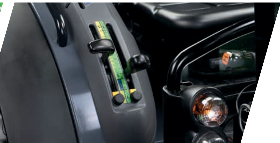
> Relevage arrière avec contrôle d'effort et de position.
