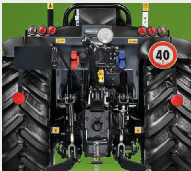
↑ Prise de force à 3 régimes et PDF proportionnelle à la vitesse d'avancement pour répondre à toutes les applications.
