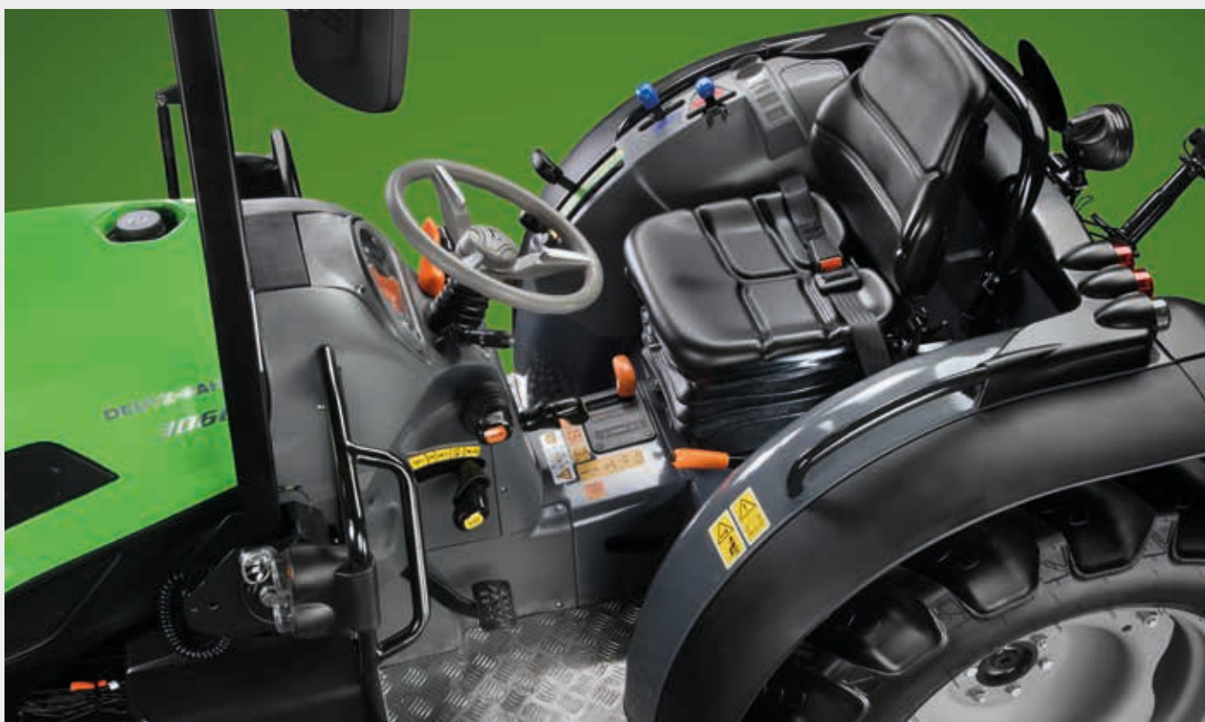
↑ Version ROPS avec plate-forme suspendue sur silentblocs.
