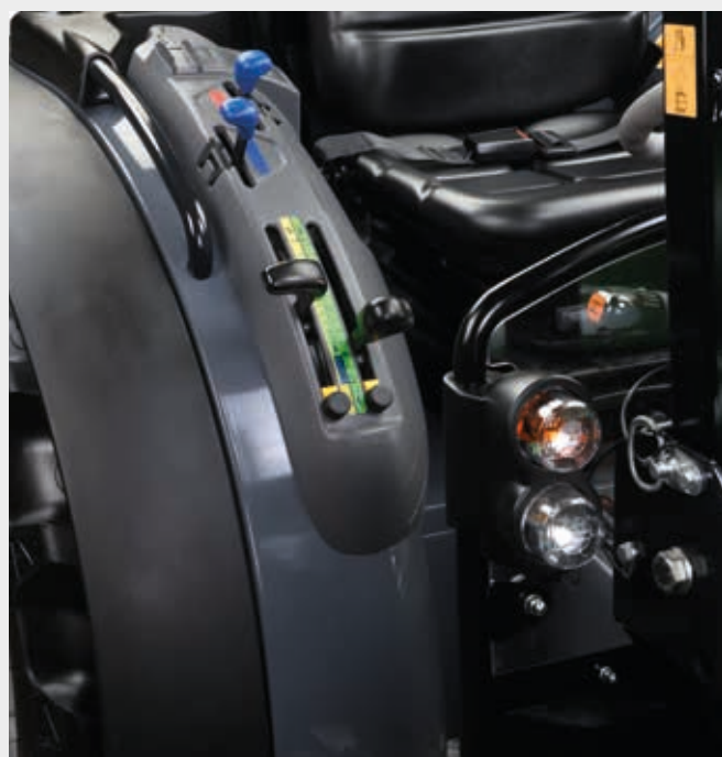
↑ Relevage arrière avec contrôle d'effort et de position.
