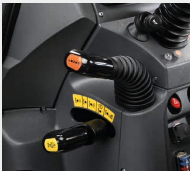
↕ Transmission mécanique avec inverseur mécanique synchronisé.
