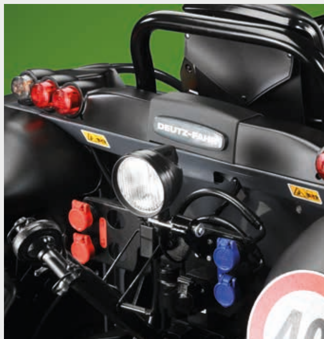
↑ Jusqu'à 6 prises hydrauliques arrière.
