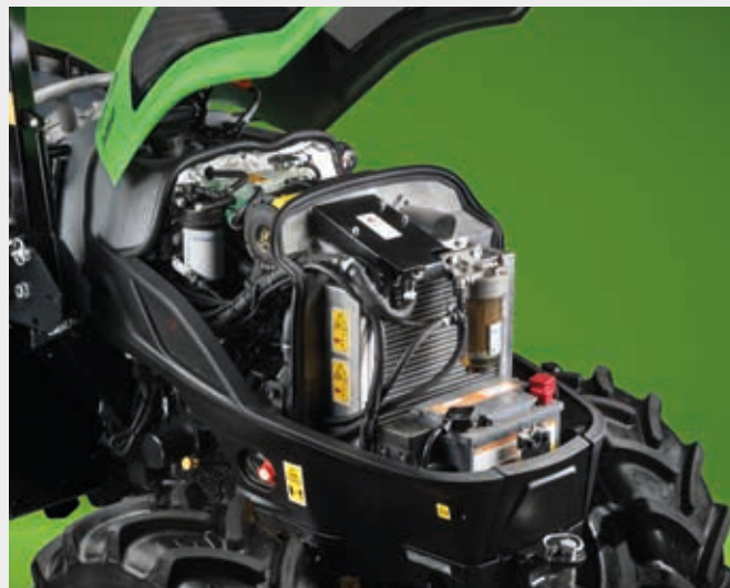
↑ Moteurs conformes à la norme Stage V avec injection à rampe commune et des puissances allant jusqu'à 59 chevaux.
