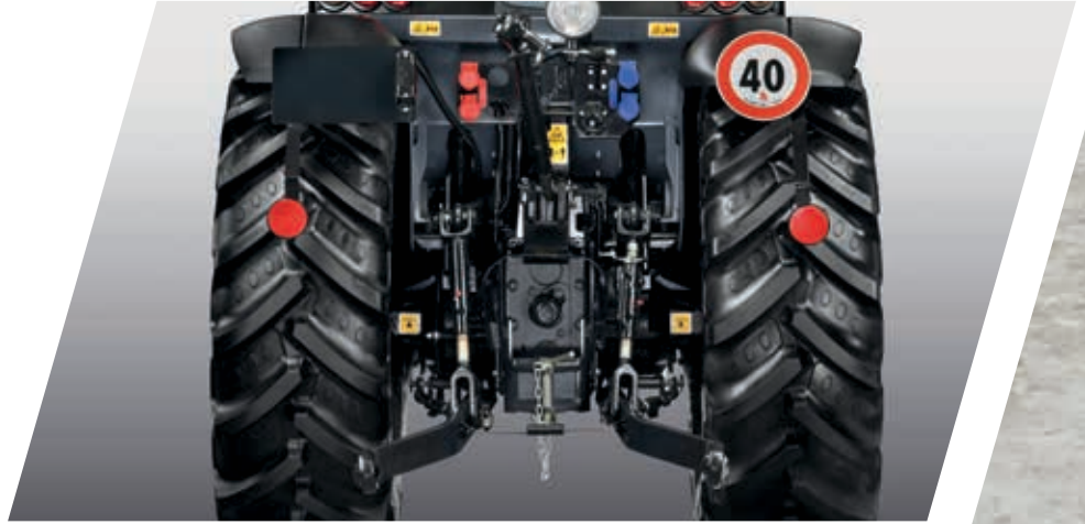
> 3 hızlı PTO ve yol kuyruk mili ile her uygulama için yeterlidir.
