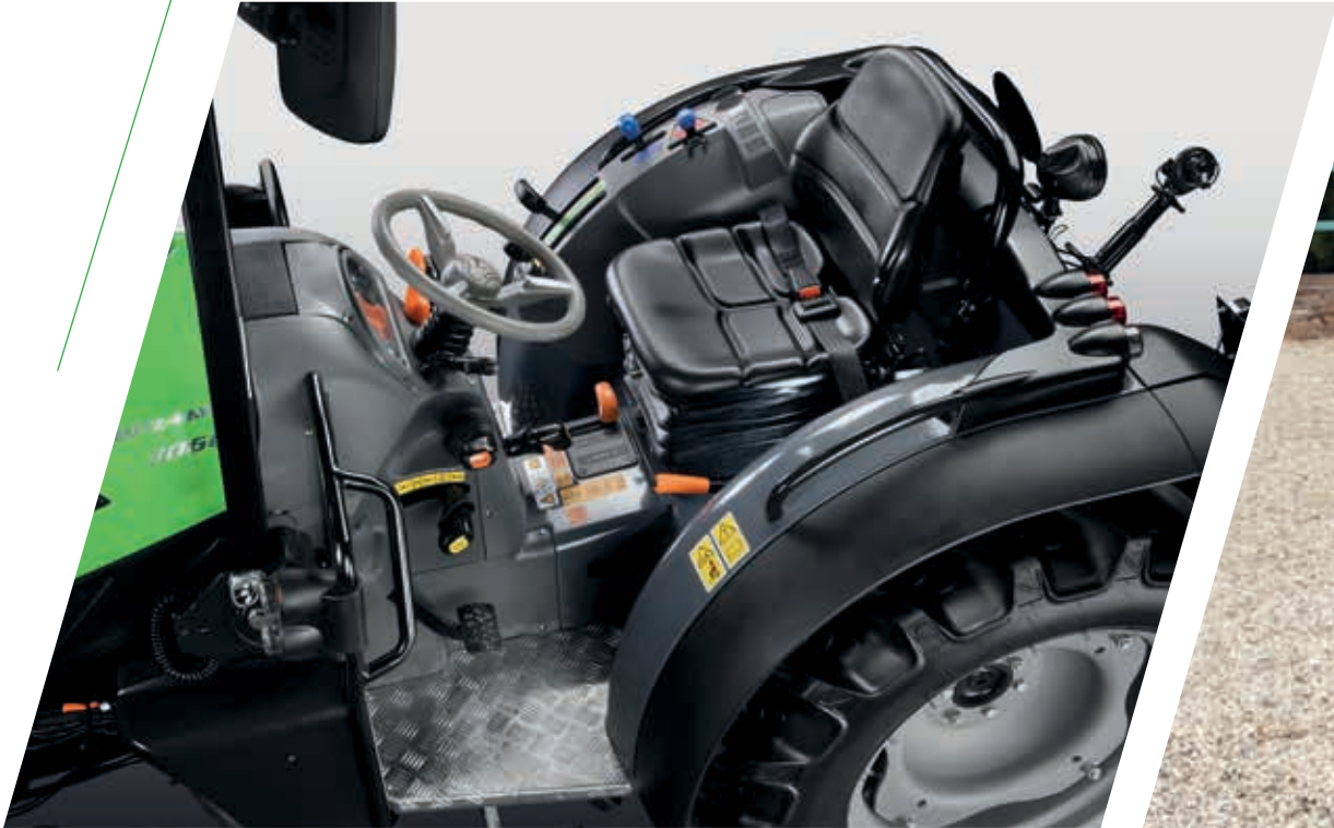
> Hydro-Silent bloklar üzerinde süspansiyonlu platforma sahip ROPS'lu versiyon.
