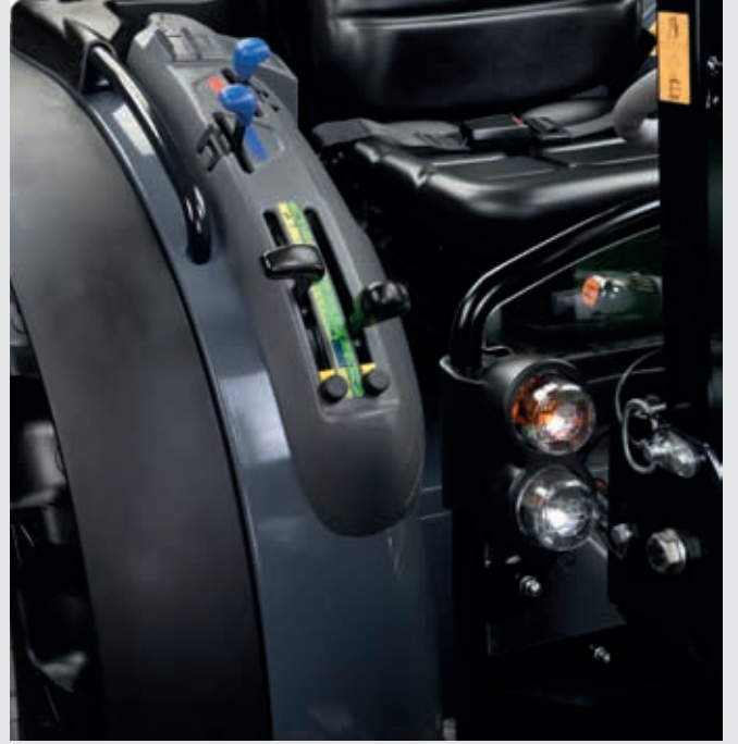
Çekme, konum ve karma kontrollü arka 3 nokta askı sistemi.
