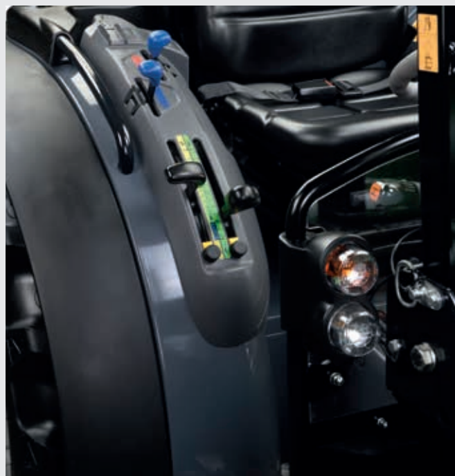
↑ Sollevatore posteriore con controlli di sforzo, posizione e misto.
