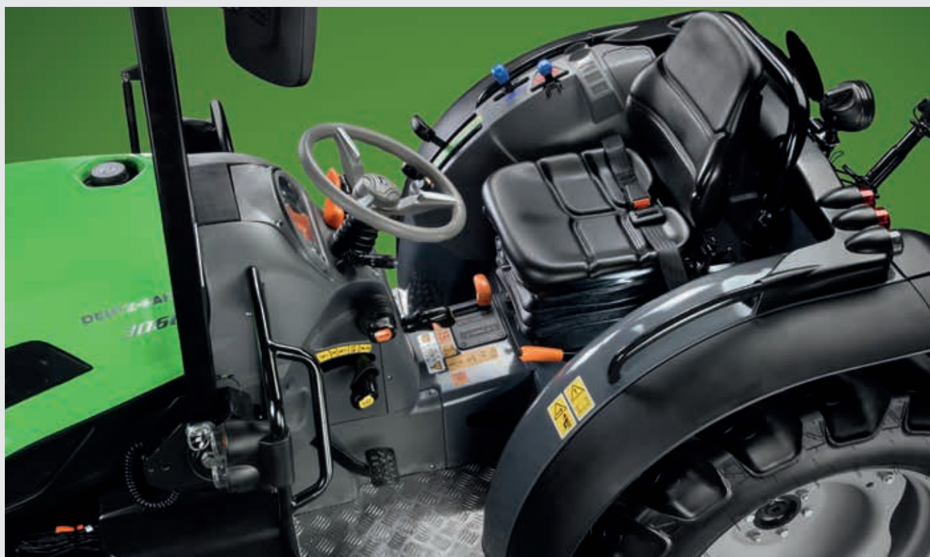
↑ Versione ROPS con piattaforma sospesa su Silent-Block.
