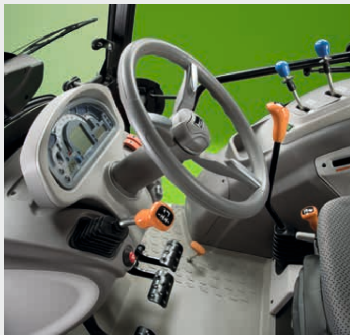
5-versnellingen transmissie en mechanische omkeerhendel op het dashboard.
