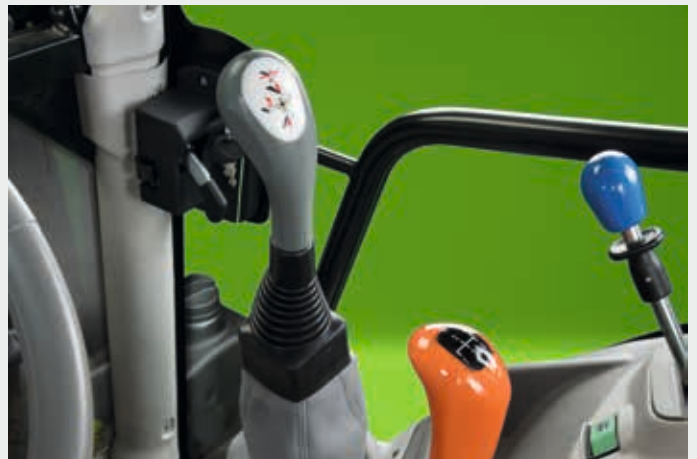
Volledig geïntegreerde joystick voor de frontlader.
