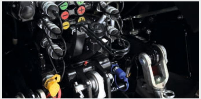
↑ Tot 3 hydrauliekventielen achter, met opbrengstregeling en een vrije hydraulische oliertour.
