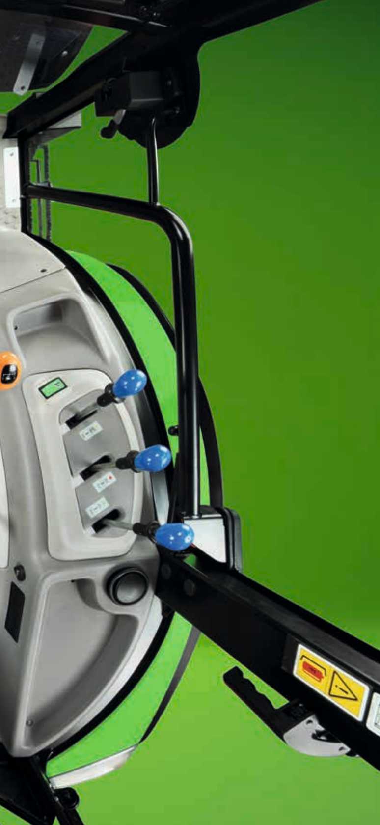
Volledig geïntegreerde joystick voor de frontlader.
