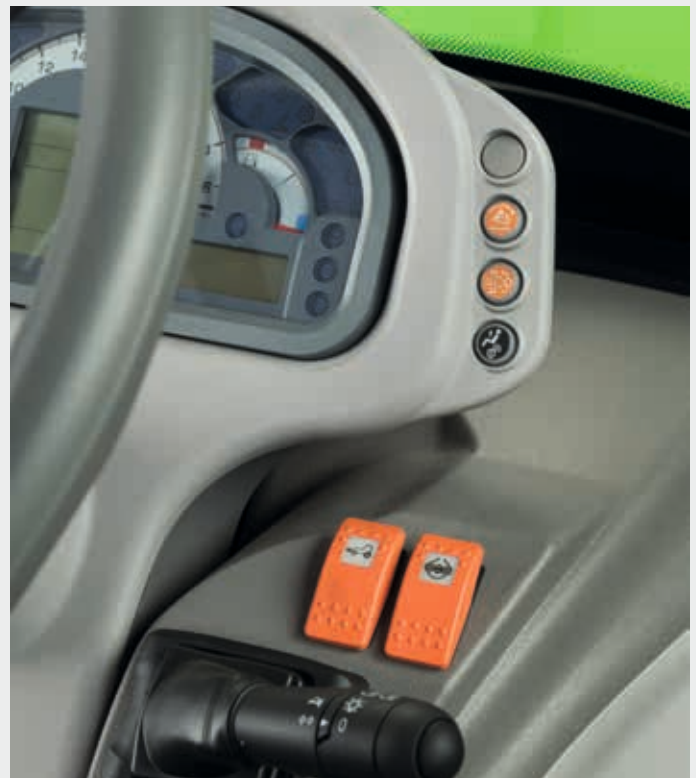
↑ Elektrohydraulische inschakeling voor 4WD en sperdifferentieel.
