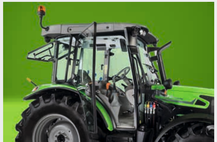
Kabina zapewnia doskonałą widoczność 360° we wszystkich kierunkach, a otwierane okna sprawiają, że otoczenie jest jeszcze wygodniejsze.
