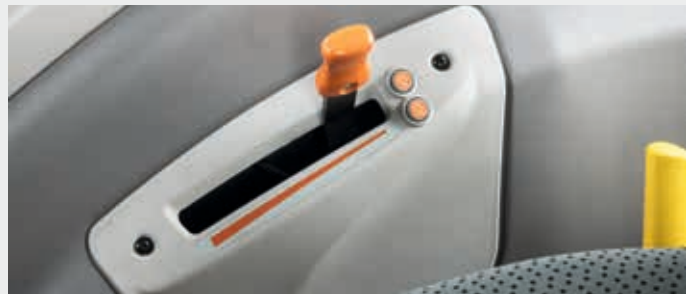
📌 Elektroniczny gaz ręczny z możliwością zapamiętania dwóch prędkości silnika.
