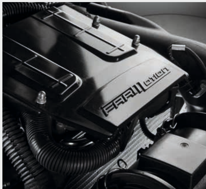
📌 Silniki FARMotion 35, zgodne z wymogami normy Stage V, z wtryskiem Common Rail, o mocy 102 KM.
