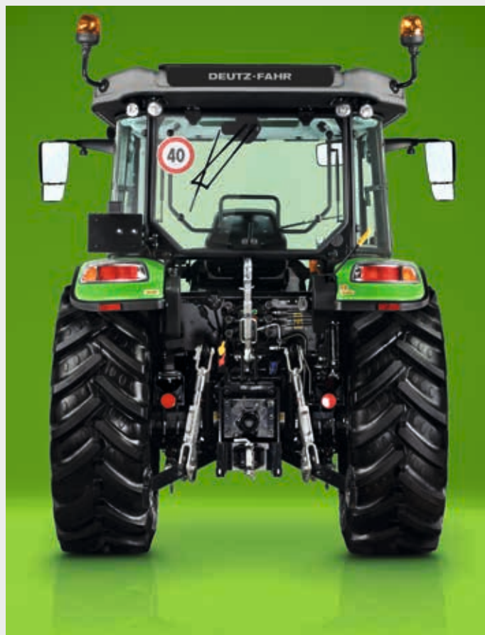
Mocny tylny podnośnik o udźwigu 3500 kg.
