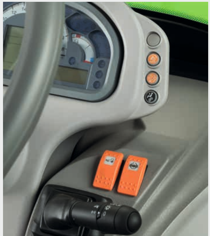
↗ Elektro-hydrauliczne załączanie napędu 4WD oraz blokady mechanizmu różnicowego.
