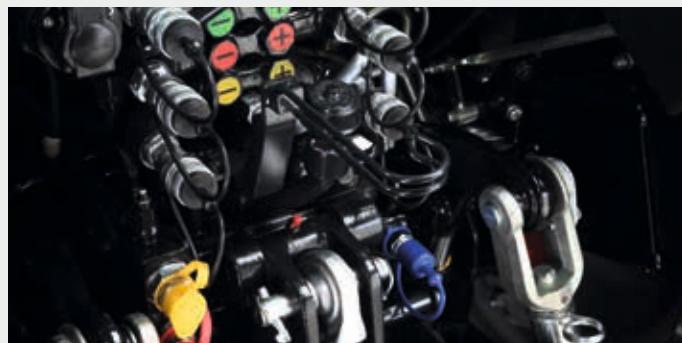
Do 3 tylnych obwodów z regulacją przepływu i funkcjami float.
