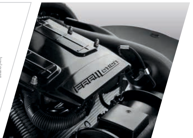
> Motores FARMotion 35 conformes com a Stage V, com injeção Common Rail e potências até 102 CV.
