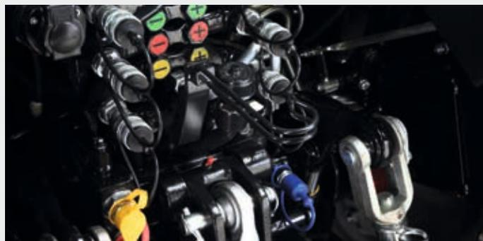
Até 3 distribuidores traseiros com regulador de fluxo e tubo de retorno do óleo do hidráulico.
