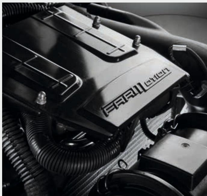
↑ Motores FARMotion 35 conformes com a Stage V, com injeção Common Rail e potências até 102 CV.
