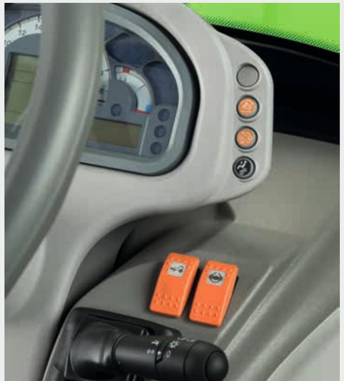
↗ Engrenamento eletro-hidráulico da dupla tração e do bloqueio dos diferenciais.
