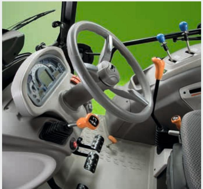
Caixa de cinco velocidades com inversor mecânico no painel de controlo.
