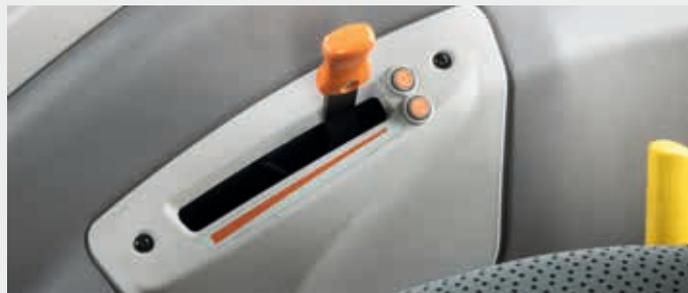
↑ Acelerador manual eletrônico com duas velocidades de memória do motor.
