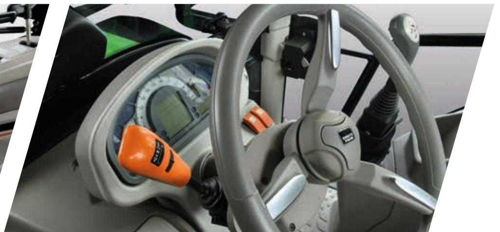
> PowerShuttle mit SenseClutch.
