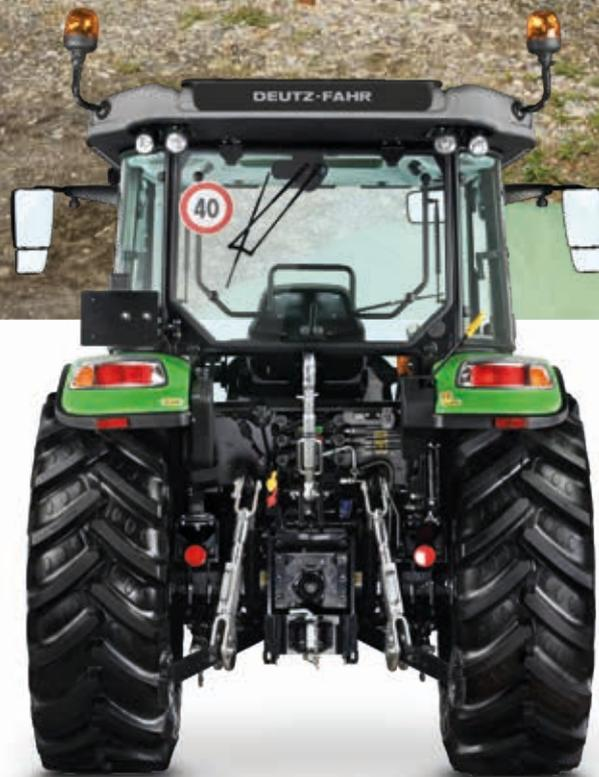
> Leistungsfähiger Heckkraftheber mit bis zu 3500 kg Hubkraft.
