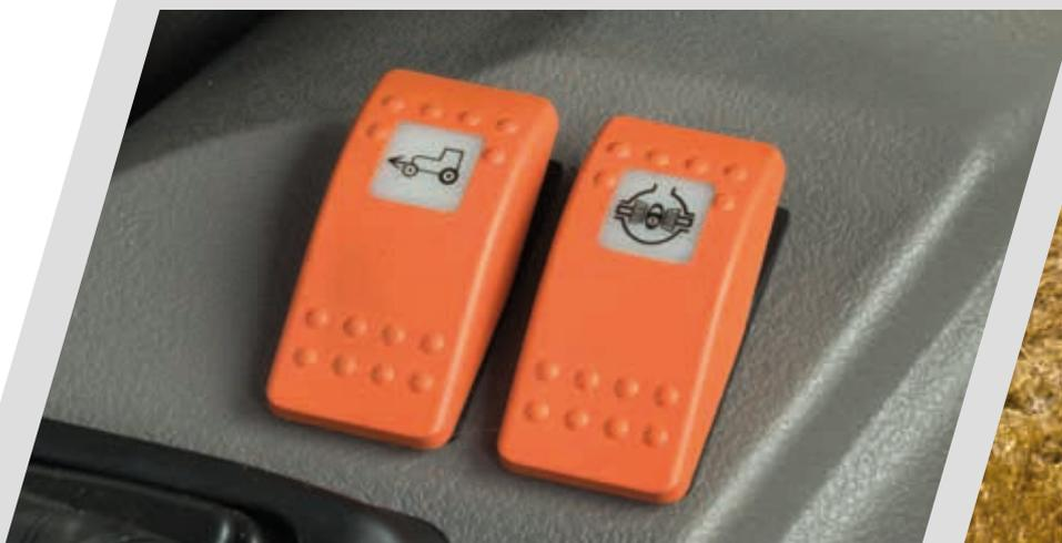
> Elektrohydraulische Zuschaltung für Allradantrieb und Differentialsperre
