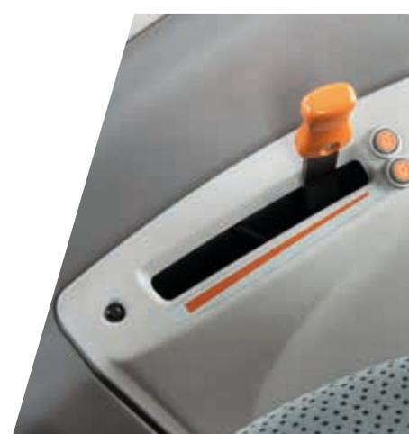
> Handgashebel mit zwei elektronisch speicherbaren Motordrehzahlen.
