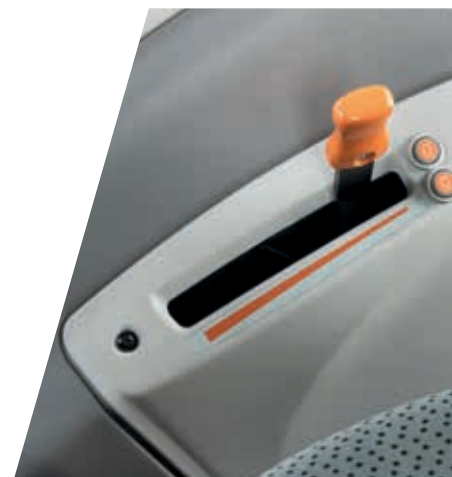
> Handgashebel mit zwei elektronisch speicherbaren Motordrehzahlen.
