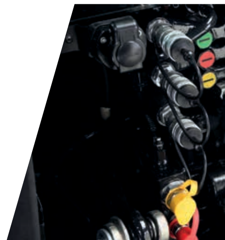
> Bis zu 3 Zusatzsteuerventile im Heck mit Durchflussregler und drucklosem Rücklauf.
