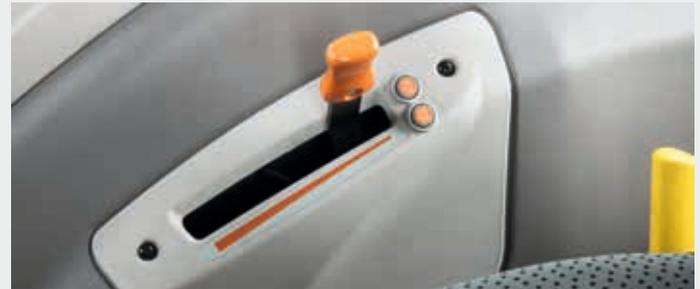
↑ Acelerador de mano electrónico con dos velocidades de memoria del motor.
