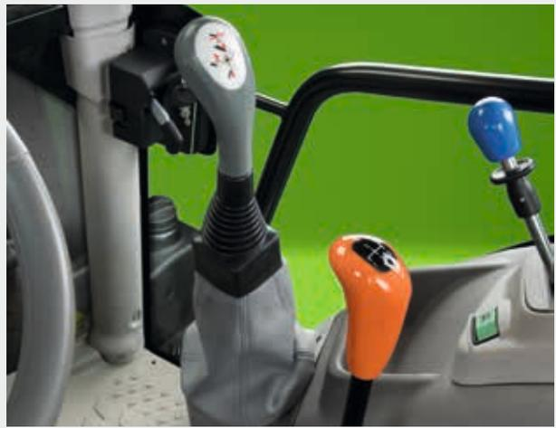
Joystick del cargador frontal totalmente integrado.
