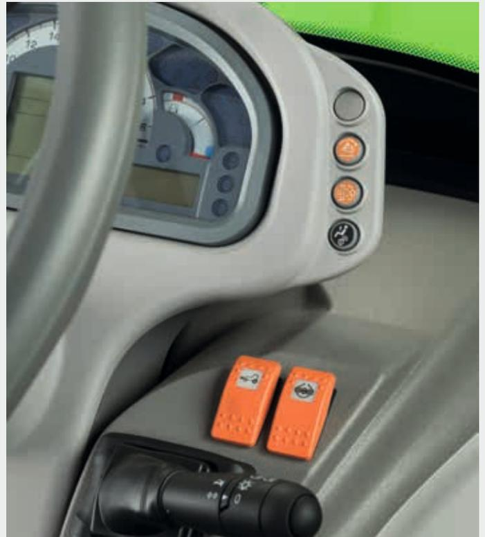
↗ Acoplamiento electrohidráulico de la doble tracción y bloqueo del diferencial.
