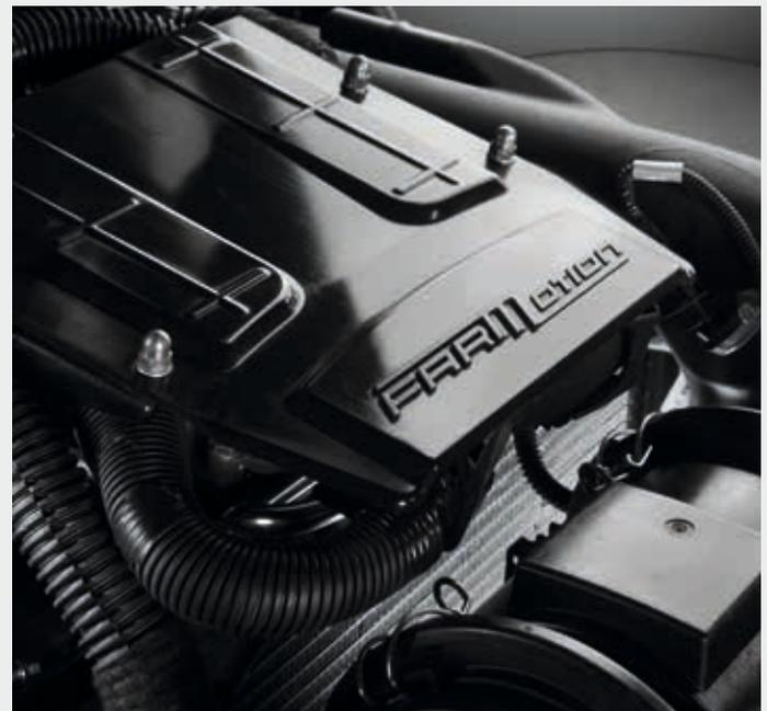
↑ Motores FARMotion 35 conformes a la Fase V con inyección common rail y potencias de hasta 102 CV.
