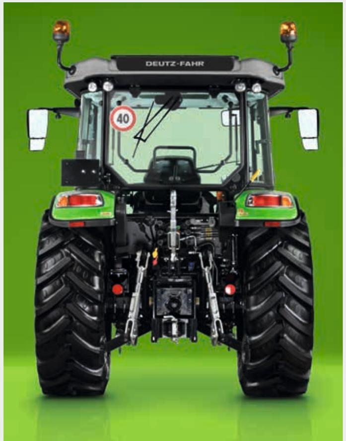
↑ Capacidad de elevación trasera de hasta 3.500 kg.
