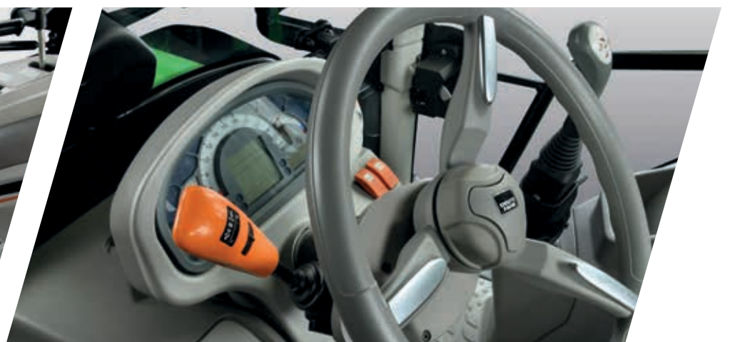
> Inverseur électrohydraulique PowerShuttle avec SenseClutch.
