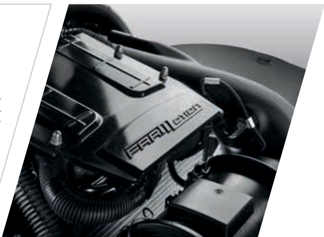
> Moteurs FARMotion 35 conformes à la norme Stage V avec injection à rampe commune et des puissances allant jusqu'à 102 chevaux.
