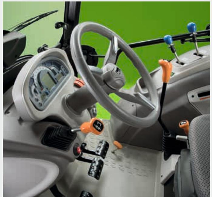
Boîte de vitesses à cinq rapports avec inverseur mécanique sur le tableau de bord.
