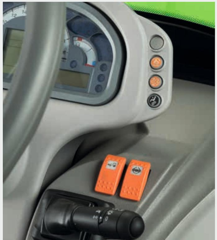
↗ Commande électrohydraulique 4RM et blocage de différentiel.
