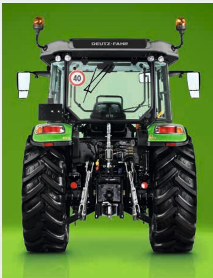
↑ Relevage arrière puissant jusqu'à 3500 kg.
