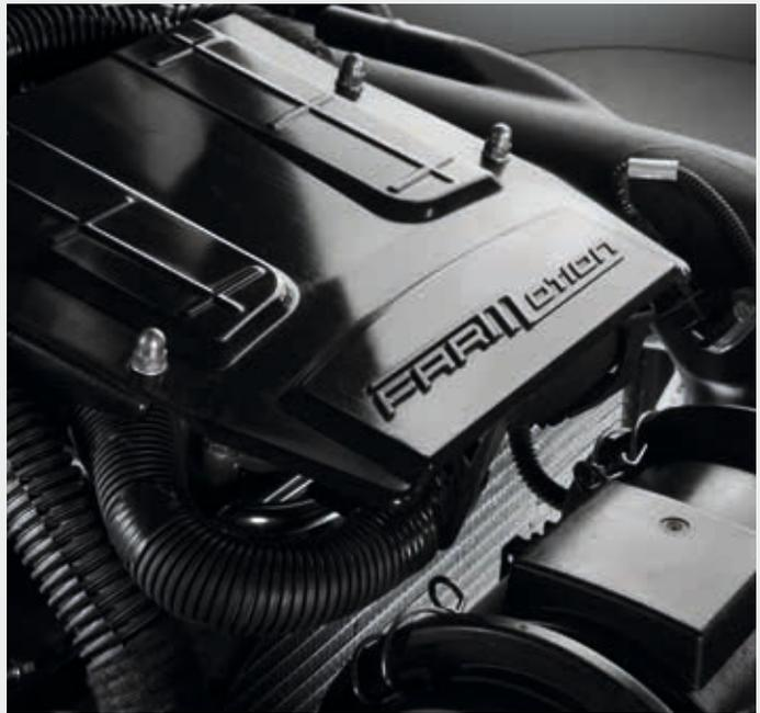
Moteurs FARMotion 35 conformes à la norme Stage V avec injection à rampe commune et des puissances allant jusqu'à 102 chevaux.
