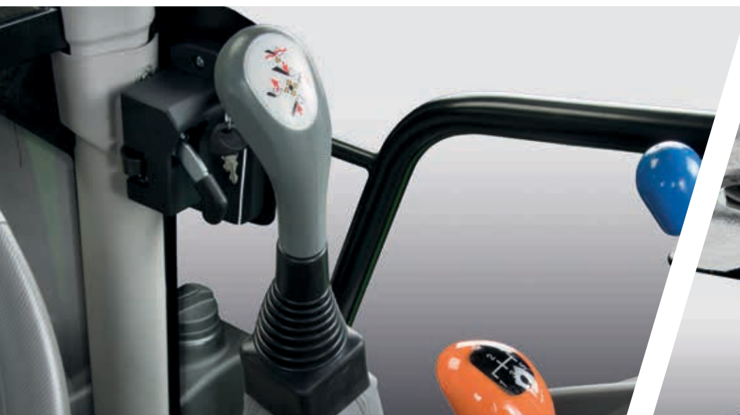
> Joystick comando caricatore frontale completamente integrato.
