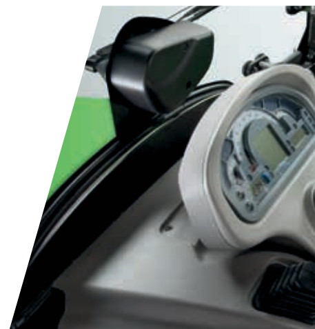
> Trasmissione a cinque velocità con inversore meccanico su plancia.
