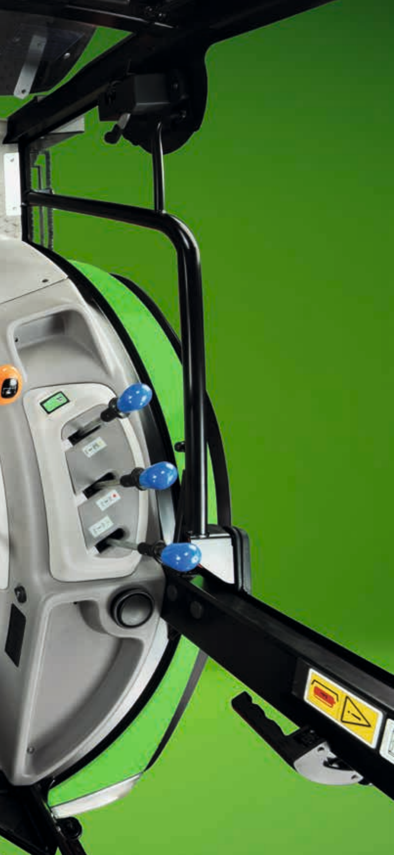
Joystick comando caricatore frontale completamente integrato.
