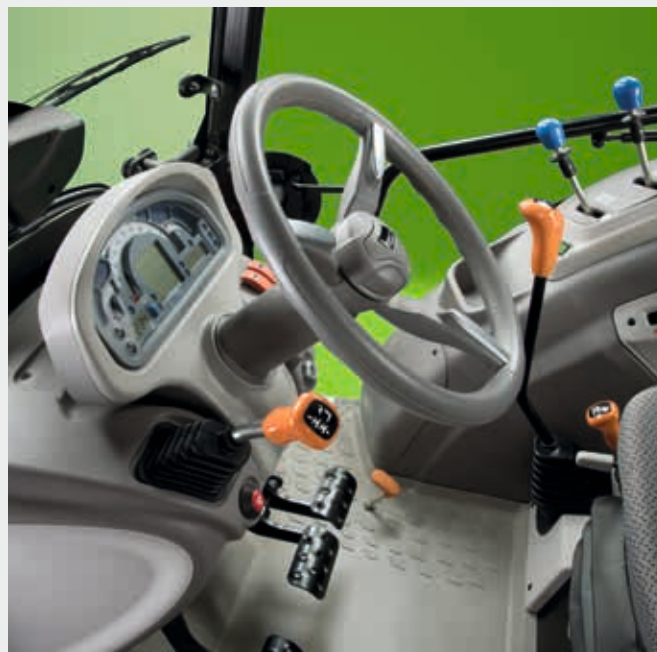
Trasmissione a cinque velocità con inversore meccanico su plancia.
