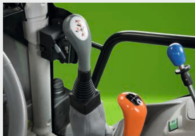
Joystick comando caricatore frontale completamente integrato.
