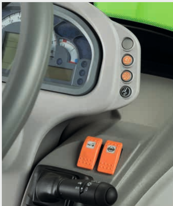
Innesto 4RM e blocco differenziale elettroidraulico.
