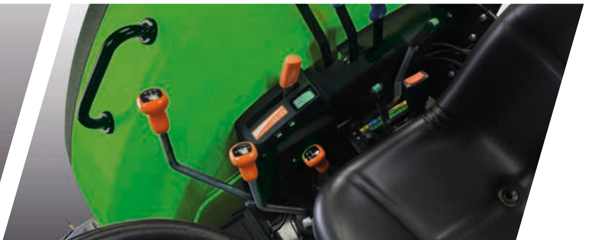
> Praktische lay-out van de besturing van de distributiekleppen en het EasyLift-systeem.
