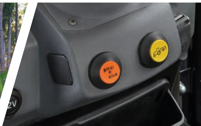
> Elektrohydraulische inschakeling aftakastoerental op modellen met PowerShuttle.
