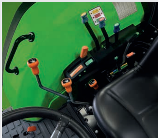
📈 Nieuwe lay-out voor de aansturing van de hydrauliekventielen en het EasyLift-systeem.
