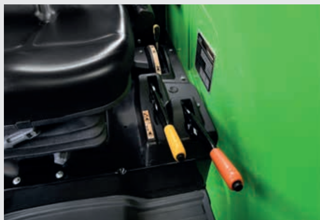
Mechanische snelheidsselectie en koppeling voor aftakas.
