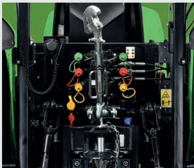
📈 Tot 3 hydrauliekventielen met doorstroomregelaar en drukloze retour.
