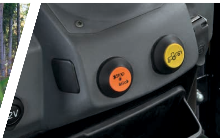
> Acionamento eletro-hidráulico da velocidade da TDF nos modelos com PowerShuttle.
