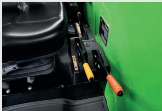
Engate e seletor de velocidade da TDF de acionamento mecânico.
