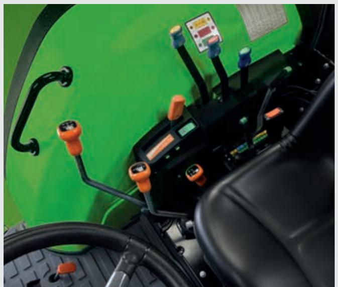
↑ Nova configuração do controle dos distribuidores e sistema EasyLift.
