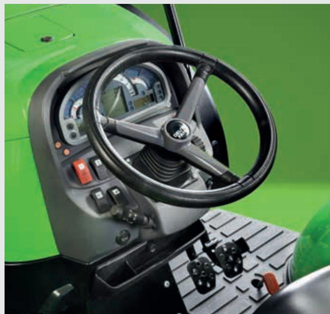
↗ Coluna de direção regulável e quadro de instrumentos digital.
