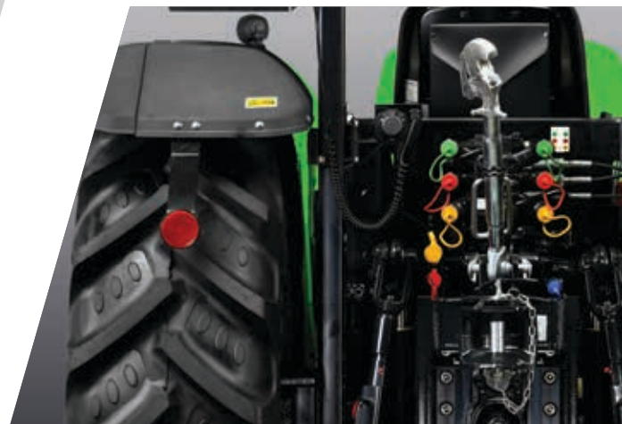
> Steuergeräte mit Durchflussregler und drucklosem Rücklauf.
