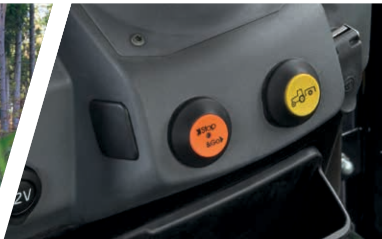
> Elektrohydraulische Zapfwellenzuschaltung bei Modellen mit PowerShuttle
