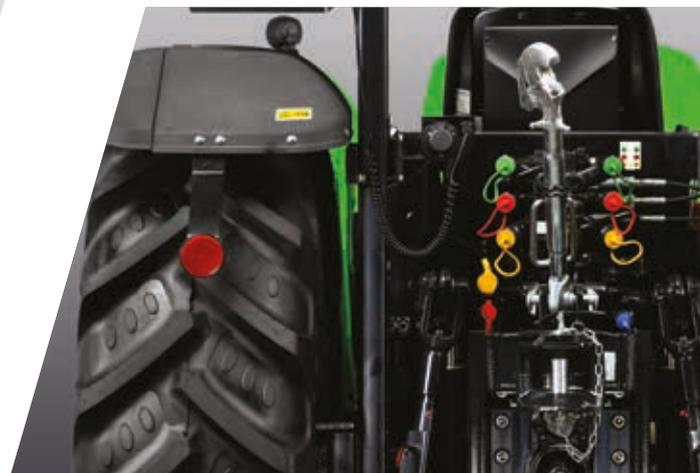
> Steuergeräte mit Durchflussregler und drucklosem Rücklauf.
