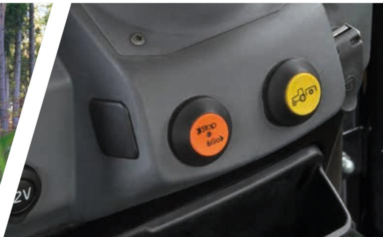
> Elektrohydraulische Zapfwellenzuschaltung bei Modellen mit PowerShuttle
