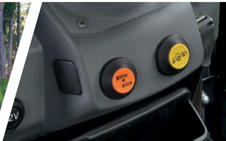
> Acoplamiento electrohidráulico de la velocidad de la TDF en modelos con PowerShuttle
