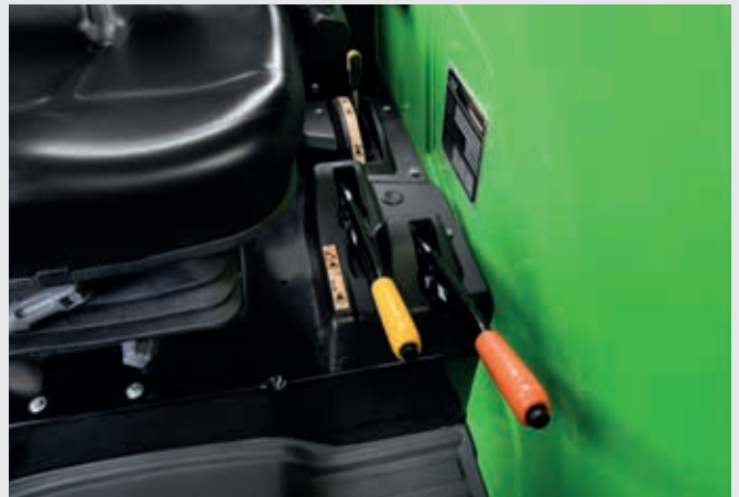
↑ Selector de velocidad y acoplamiento mecánico de la TDF.
