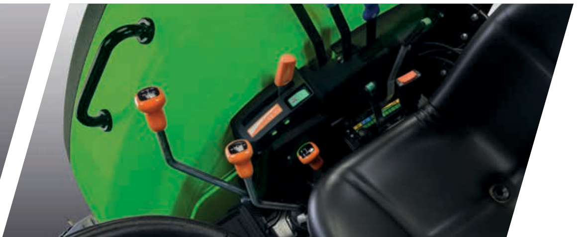
> Comoda disposizione dei comandi dei distributori e sistema EasyLift.
