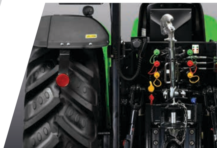
> Fino a 3 distributori con regolatore di flusso e scarico libero.
