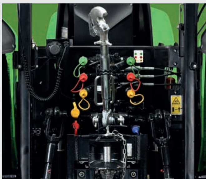
📈 Fino a 3 distributori con regolatore di flusso e scarico libero.
