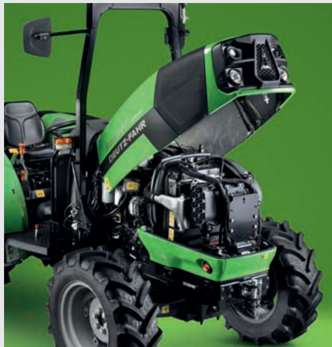
↑ Łatwa konserwacja dzięki szeroko otwieranej, jednoczęściowej pokrywie silnika.
