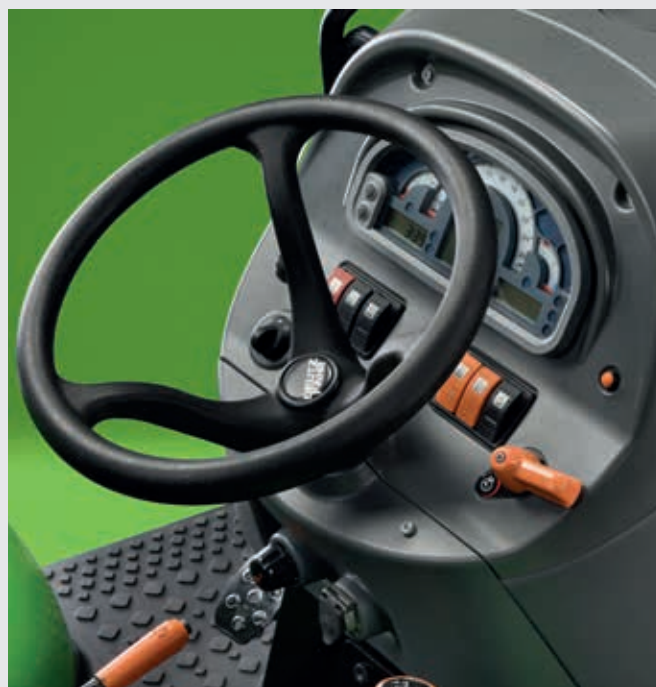
↑ Pamięć prędkości obrotowej silnika. Zapisywanie i przywoływanie prędkości obrotowej silnika przez naciśnięcie przycisku.
