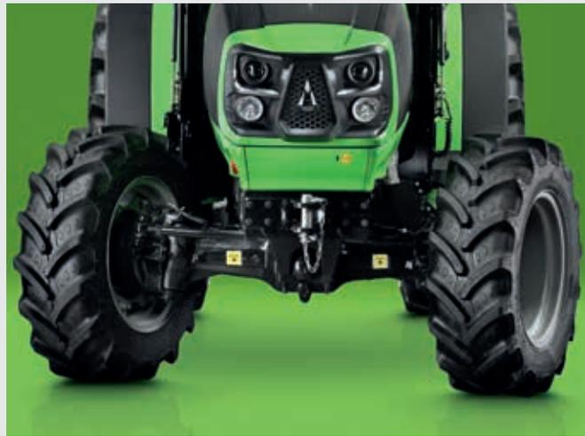
↑ Echtes Vierradbremssystem dank gebremster Vorderachse.
