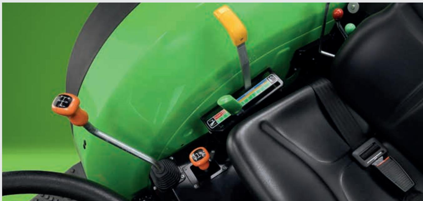
↑ Relevage arrière mécanique précis avec un contrôle facile.
