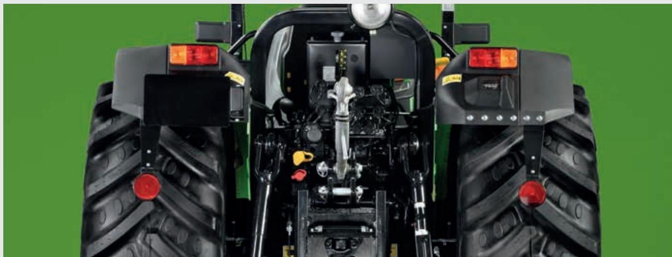
↑ Jusqu'à 3 distributeurs mécaniques arrière.
