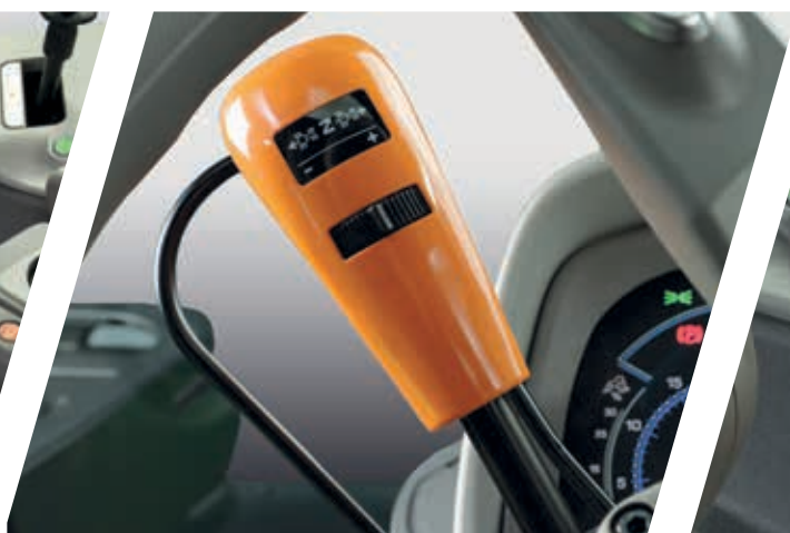
> Levier d'inverseur PowerShuttle avec molette de réglage SenseClutch.
