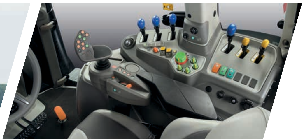
> Équipement de cabine MaxiVision avec distributeurs arrière entièrement mécaniques en combinaison avec la transmission Powershift (grande photo) et RCshift (photo ci-dessus).
