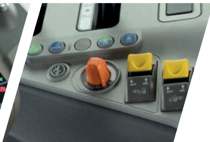
> Facile et intuitif – avec le bouton de réglage ECO/Power, l'opérateur peut modifier le comportement de changement de vitesse de l'APS (Automatic Powershift).
