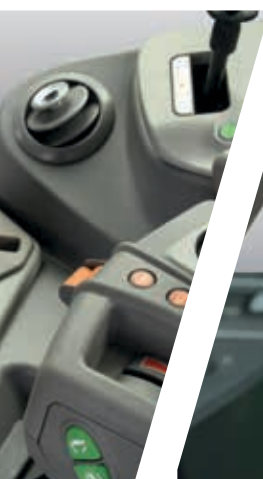
> Levier d'inverseur PowerShuttle avec molette de réglage SenseClutch.
