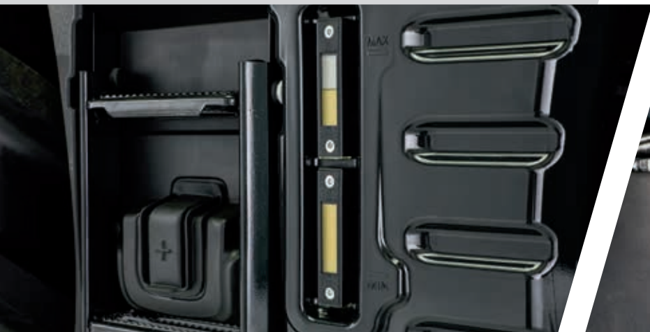
> Port de démarrage d'appoint et hublot de niveau d'huile.
