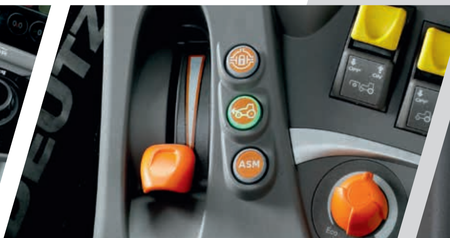
> 4 roues motrices et blocage de différentiel à commande électrohydraulique avec bouton ASM et accélérateur manuel indépendant.
