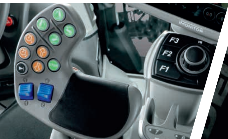
> Joystick MaxCom ergonomique.
