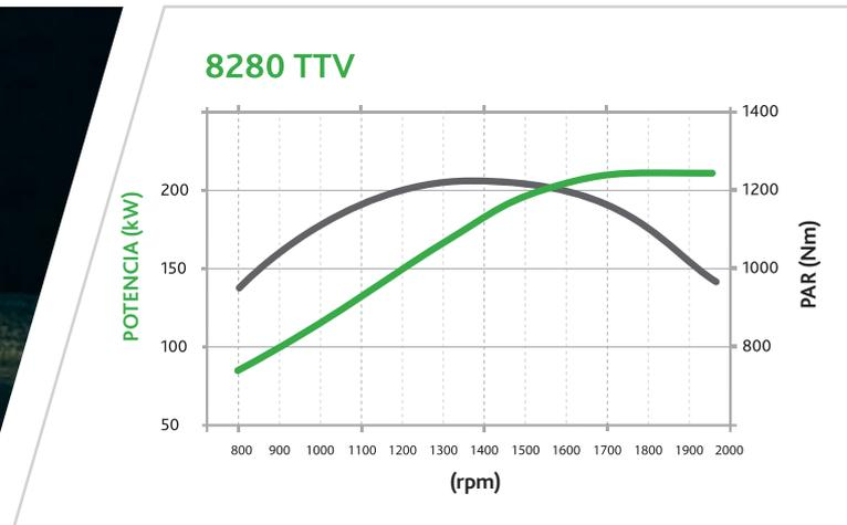
> Altos valores de par y potencia en una amplia gama de revoluciones.
