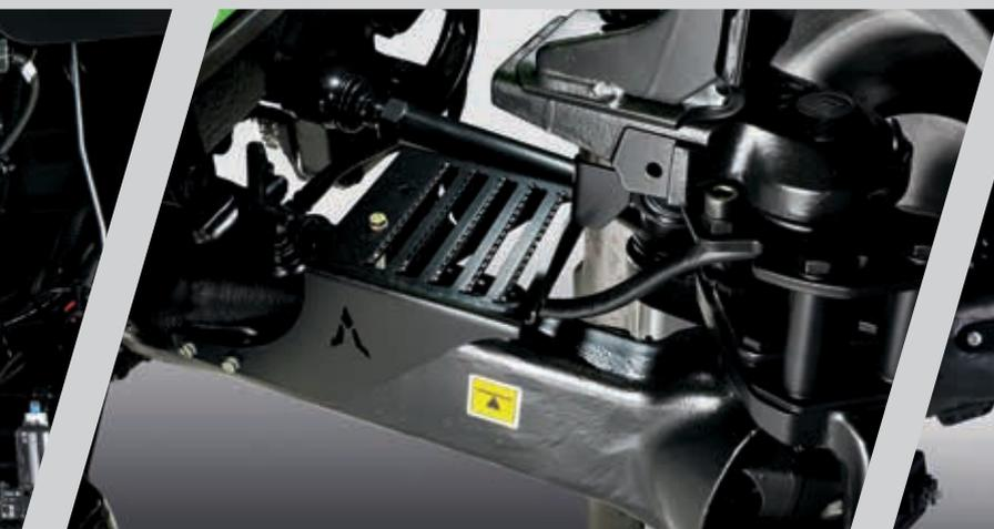
> Estribos de mantenimiento encima del eje delantero para una limpieza cómoda.
