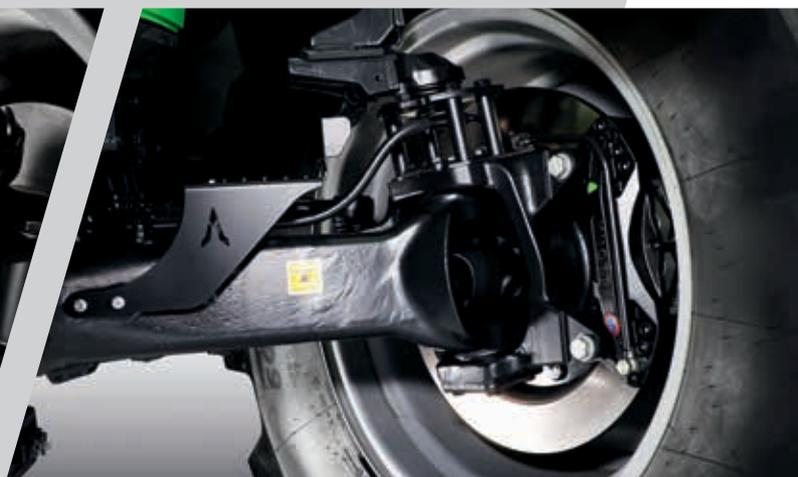
> Frenos de disco en seco para las máximas prestaciones de frenado.
