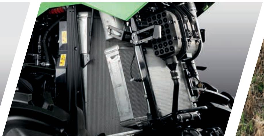
> Radiador con mecanismo de apertura sencillo, prefiltro y filtro de aire PowerCore.
