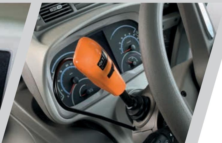
> Inversor electrohidráulico con SenseClutch.
