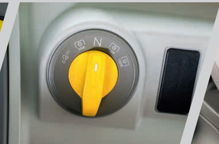
> Електрогідравлічне вмикання ВВП.
