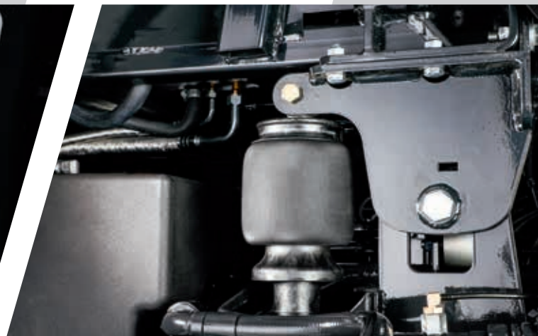
> Пневматичній підвісці кабіни для плавної їзди.
