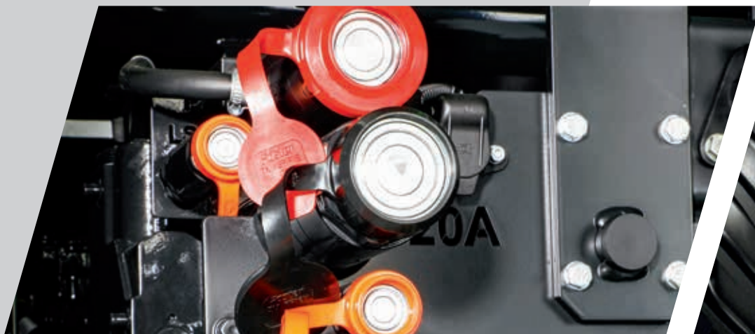
> Power Beyond з опційними плоскими муфтами для чистого з'єднання.
