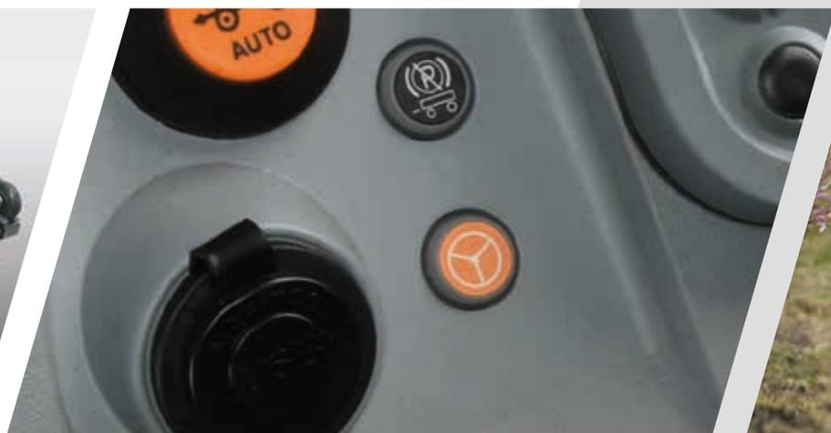
> La fonction SDD permet de diviser par deux le nombre de tours de volant nécessaires pour un braquage d'une position extrême à l'autre.
