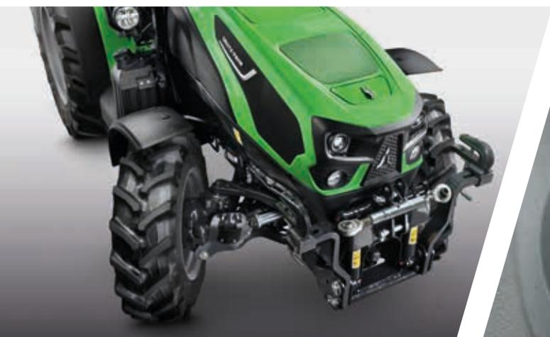
> Suspension indépendante du pont avant à commande électronique pour un meilleur confort et une meilleure traction.
