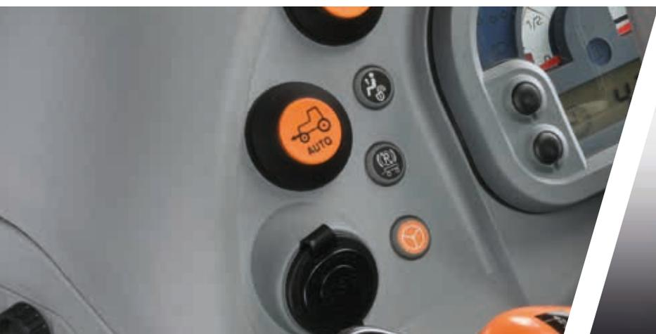
> La fonction 4RM Auto engage et désengage automatiquement les 4 roues motrices en fonction de l'angle de braquage.
