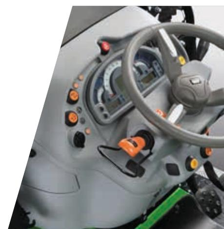
> Inverseur électrohydraulique PowerShuttle avec SenseClutch à 5 niveaux de réglage.
