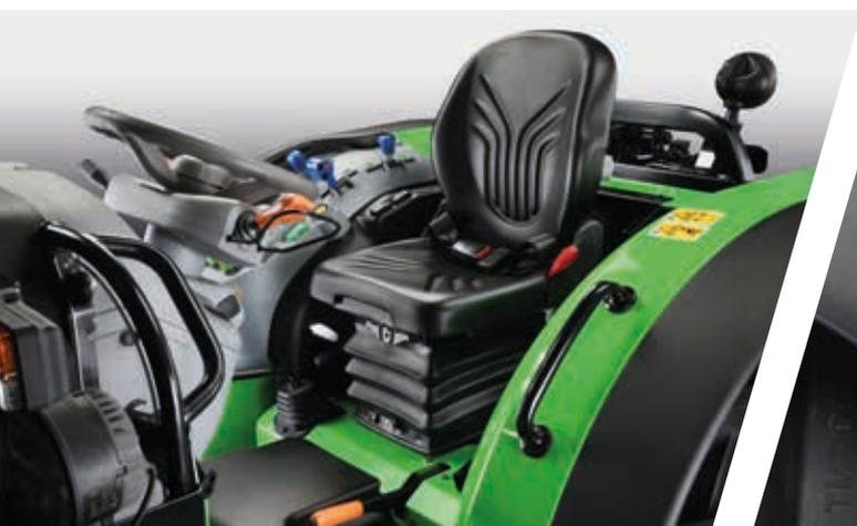
> Siège conducteur à suspension pneumatique pour un meilleur confort.
