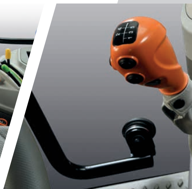
> Levier de vitesse ergonomique avec commandes des Powershift et ComfortClutch.
