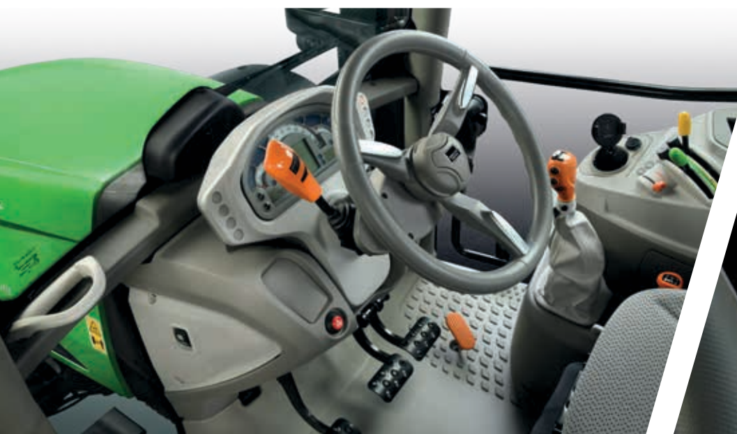
> Inverseur électrohydraulique PowerShuttle avec SenseClutch à 5 niveaux de réglage et fonction Stop&Go.
