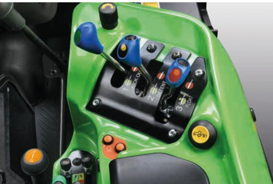
> Leichtes Zuschalten der Heckzapfwelle mit Drucktaste.
