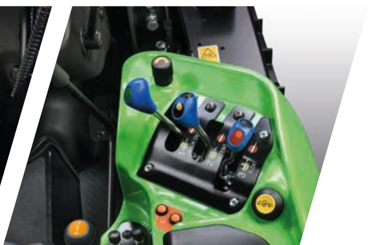
> Der Ölfluss lässt sich über einen speziellen Drehknopf an der Seitenkonsole bequem einstellen.
