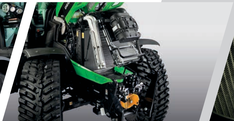
> Aluminium koelsysteem Performance pro met een hendel voor ontgrendeling met één hand voor modellen 6210-6230.
