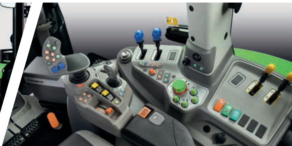
> Gemengde configuratie met 2 mechanische ventielen en 2 elektrische ventielen.
