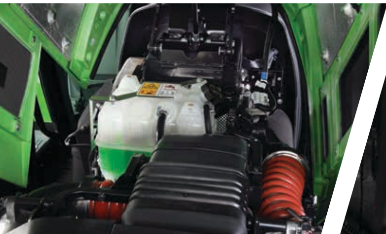
> Gemakkelijk te openen motorkap en koelvloeistoftank.
