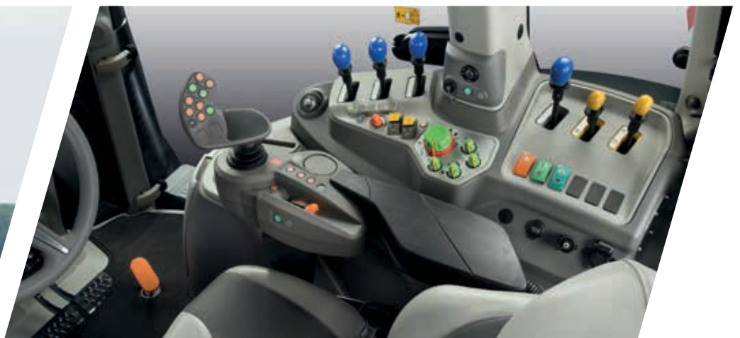
> MaxiVision-cabineitvoering met volledig mechanische hydrauliekventielen achter is beschikbaar voor Powershift- (grote afbeelding) en RCshift-modellen (afbeelding boven).
