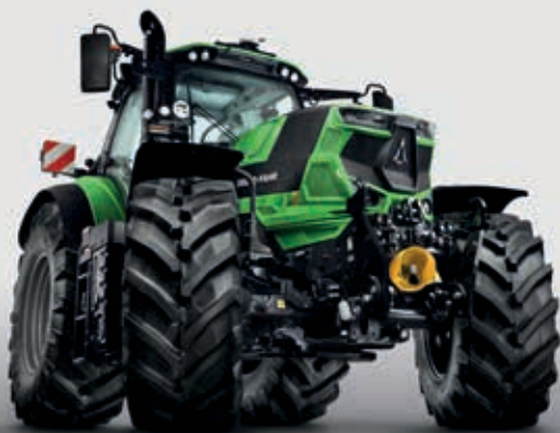
> Przednia oś amortyzowana ze 100% blokadą przedniego mechanizmu różnicowego.
