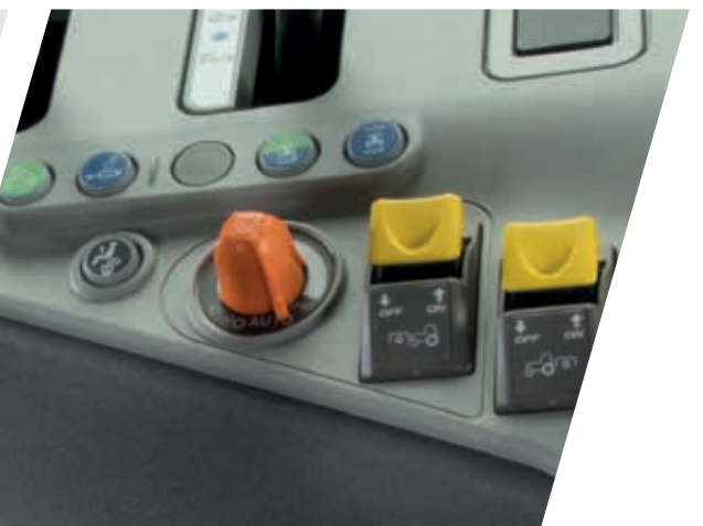
> Prosta i intuicyjna – za pomocą pokrętła regulacji Eco/Power operator może zmienić sposób przełączania przełożeń APS (automatycznej zmiany biegów Powershift).
