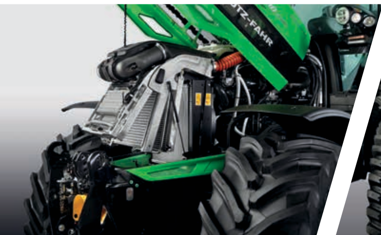
> Aluminiowy układ chłodzenia Performance + z dźwignią zwalnającą obsługiwaną jedną ręką do modeli 6160-6190.
