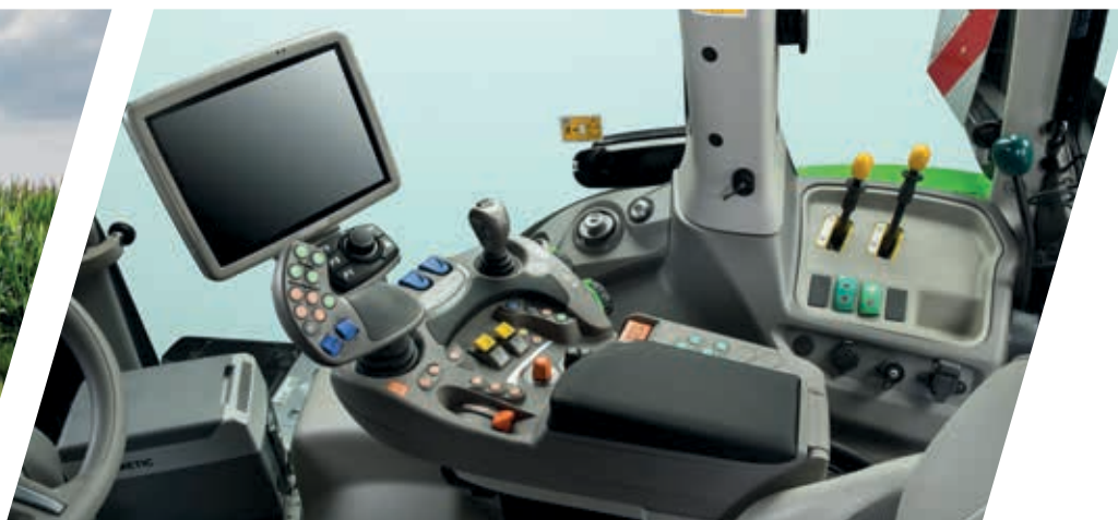
> Ergonomiczny joystick MaxCom z przyciskami do obsługi podnośników, sterowania silnikiem/przekładnią, pracą na uwrotkach i dwoma proporcjonalnymi obwodami hydraulicznymi.
