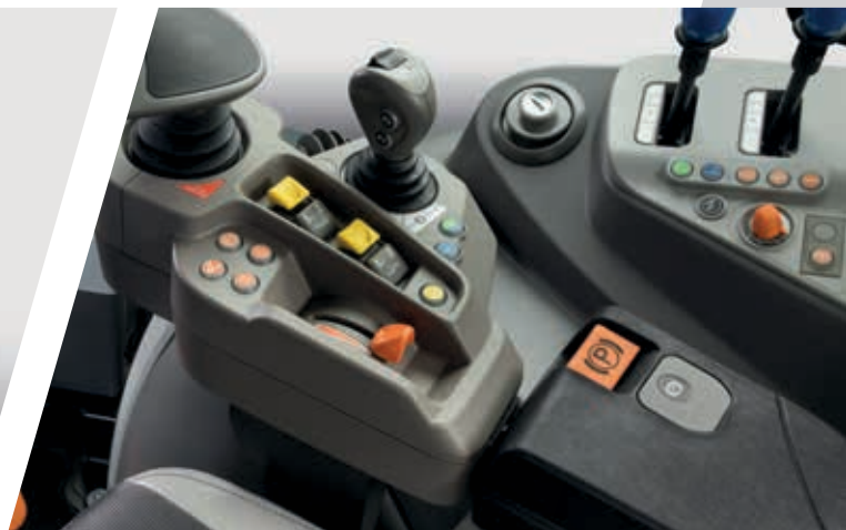
> Elektroniczny hamulec postojowy (EPB) w modelach TTV.
