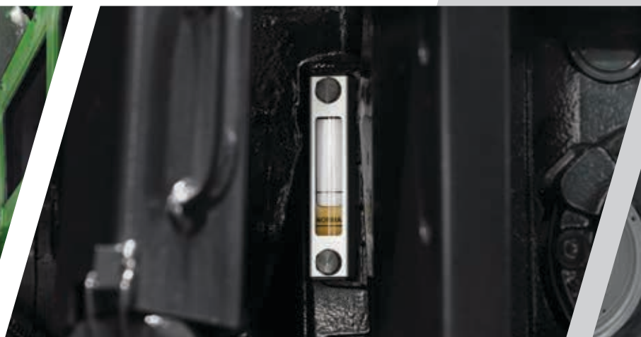
> łatwy w użyciu wziernik oleju z tyłu ciągnika.
