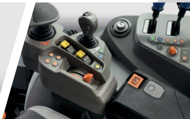
> Freno Park Brake electrónico (EPB) en los modelos TTV.
