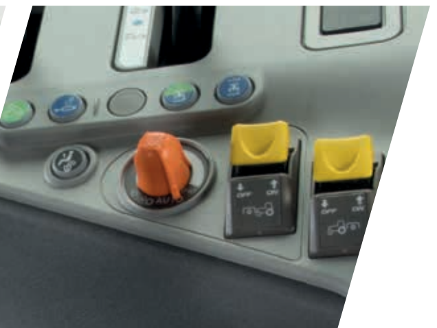
> Fácil e intuitivo: con el selector de ajuste Eco/Power el operador puede cambiar el comportamiento del cambio APS (Automatic Powershift)
