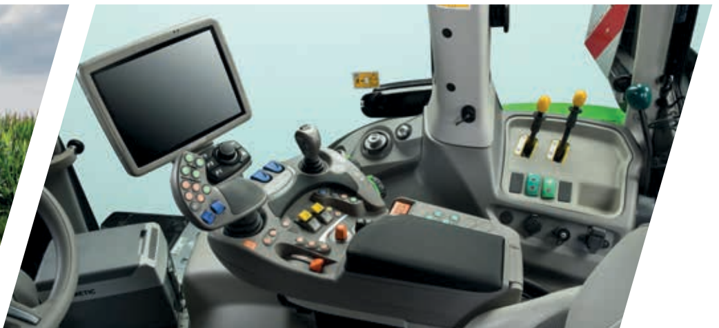
> Joystick ergonómico MaxCom con botones de elevación, control del motor y la transmisión, botón para la gestión de las cabezeras y dos distribuidores hidráulicos proporcionales.
