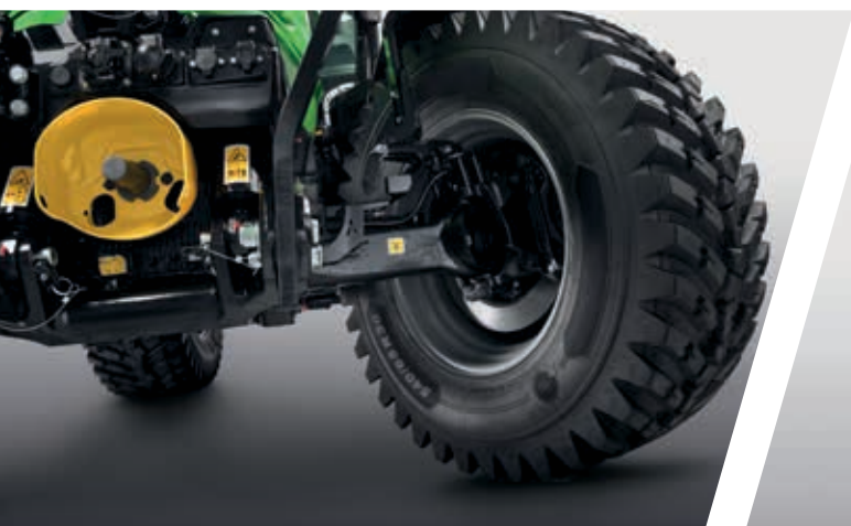
> Los frenos de disco en seco opcionales de los modelos 6210 y 6230 ofrecen una potencia de frenado excepcional.
