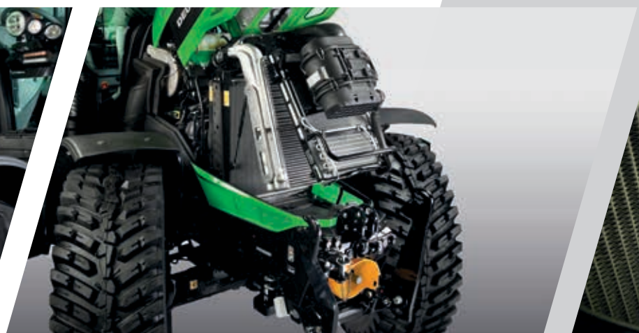
> Sistema di raffreddamento in alluminio Performance pro con leva di sgancio azionabile con una mano per i modelli 6210-6230.
