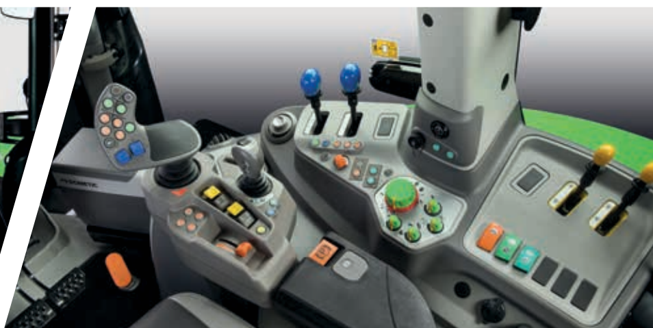
> Configurazione mista con 2 distributori meccanici e 2 elettrici.
