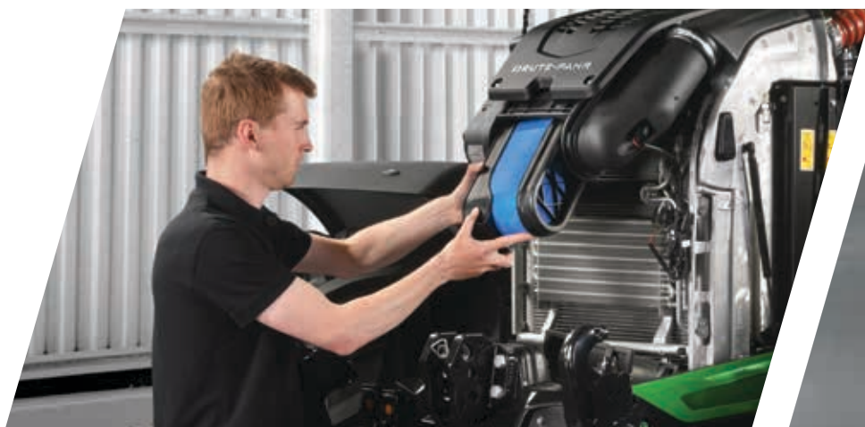
> Tutti i modelli sono dotati di un filtro dell'aria comburente PowerCore per garantire una lunga durata utile.
