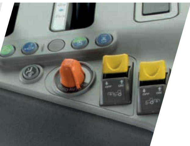
> Uso facile e intuitivo – con la manopola di regolazione Eco/Power, l'operatore può modificare la modalità di innesto dell'APS (Automatic Powershift).
