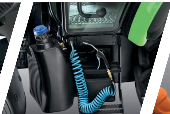
> Conexiones de aire externas y en cabina para accesorios de compresores de aire.
