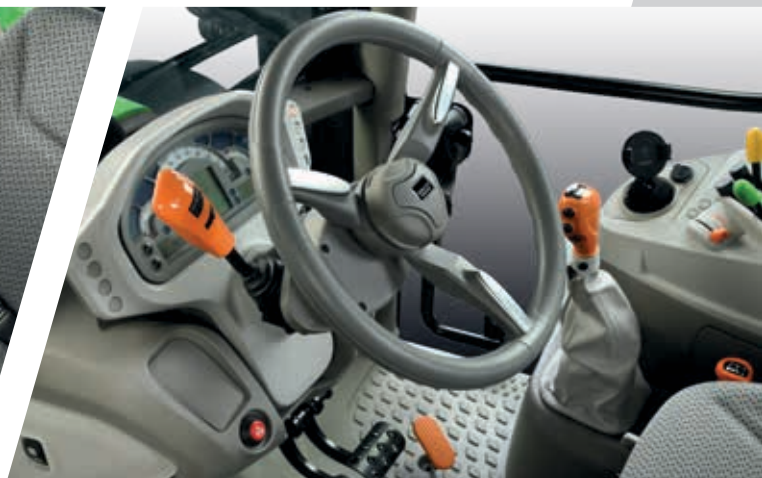
> PowerShuttle con SenseClutch con ajuste de 5 niveles y función Stop&Go.
