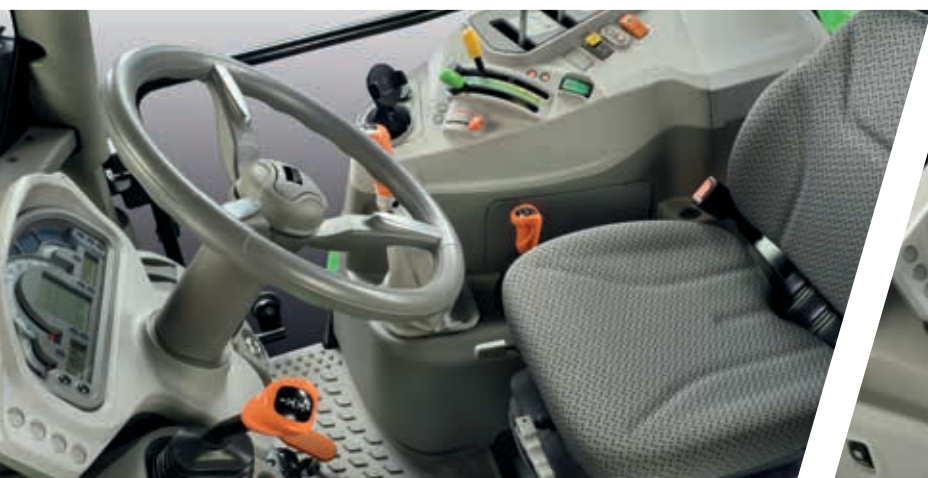
> Механічний перемикач з ергономічним важелем на кермовій колонці.
