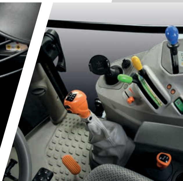
> Ергономічне та організоване бічне керування з механічним заднім підйомником для моделей 5095 - 5105 - 5105 HD.
