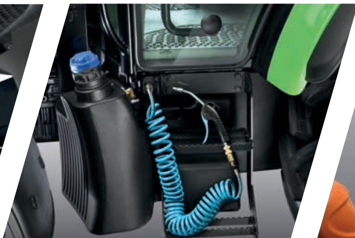
> Зовнішні та внутрішні пневматичні з'єднання для аксесуарів пневматичного компресора.
