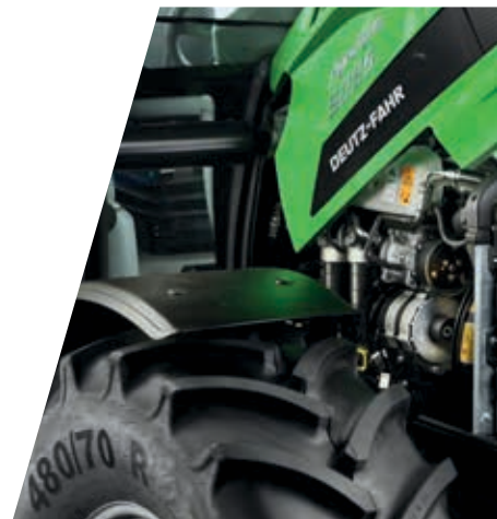
> Двигун FARMotion потужністю від 95 до 126 к.с.
