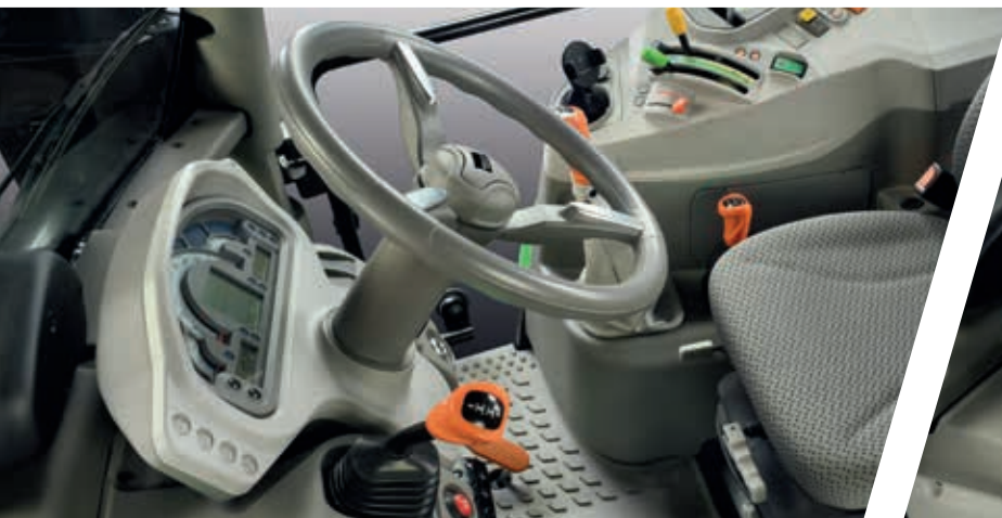
> Mechanische omkeerschakeling met ergonomische hendel op het dashboard.
