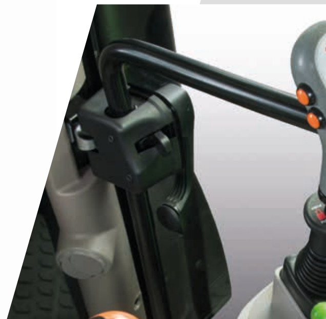
> Joystick met Powershift-bediening om de voorlader gemakkelijk te bedienen.
