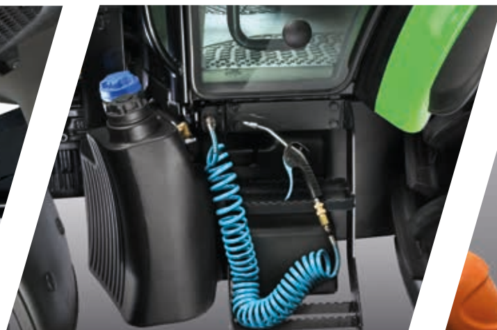
> Luchtaansluitingen buiten en in de cabine voor luchtcompressortoebehoren.
