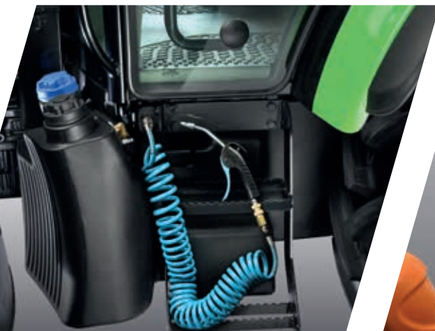
> Złącza pneumatyczne w kabinie i na zewnątrz.
