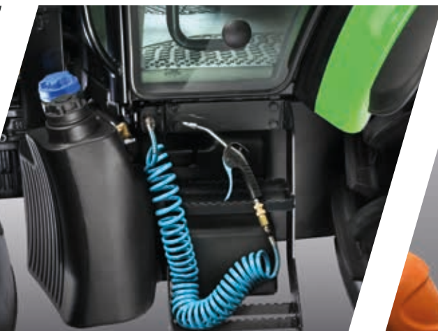
> Złącza pneumatyczne w kabinie i na zewnątrz.
