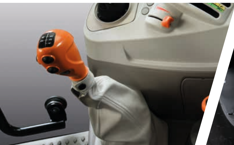
> Alavanca de velocidades ergonómica com comandos da transmissão Powershift e ComfortClutch.
