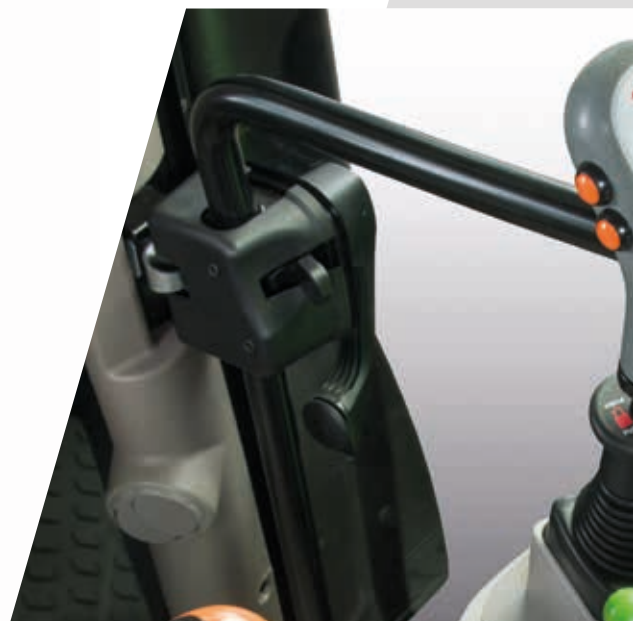
> Joystick com controlo Powershift para um movimento fácil do carregador frontal.
