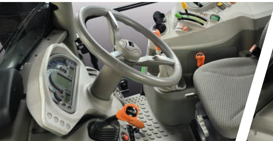
> Mechanisches Wendegetriebe mit ergonomischem Hebel an der Lenksäule.
