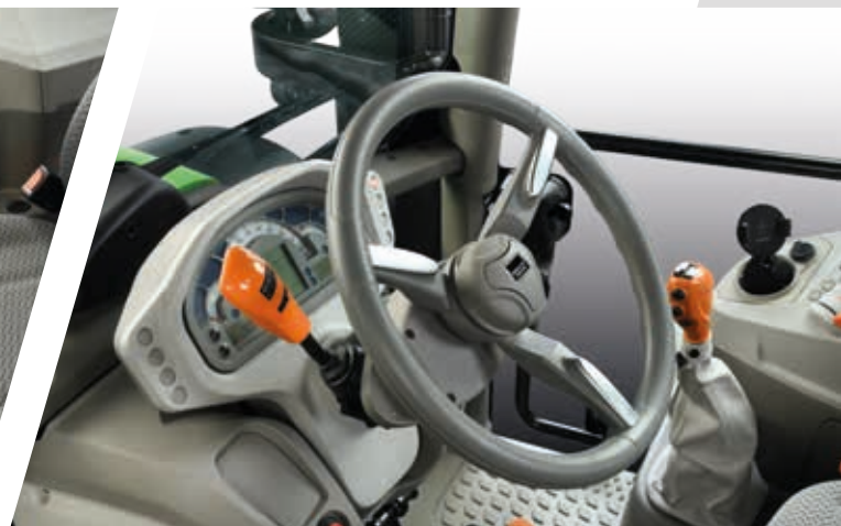
> PowerShuttle mit SenseClutch (5 Einstellstufen) und Stop&Go-Funktion.
