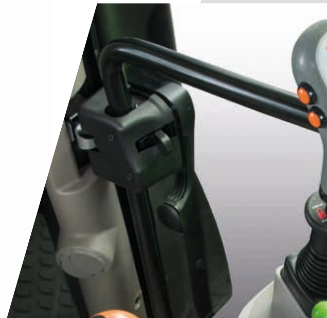
> Joystick mit Powershift-Steuerung für die einfache Bedienung des Frontladers.
