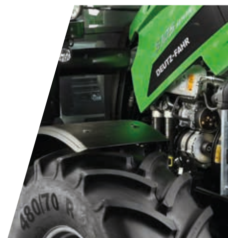
> FARMotion 45-Motor mit Leistungen von 75 bis 106 PS mit oder ohne SCR.
