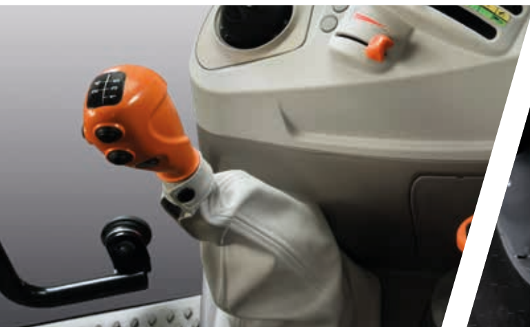
> Ergonomischer Schalthebel mit Powershift-Getriebebestuerung und ComfortClutch.
