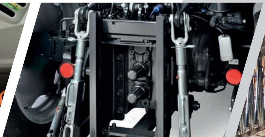
> PTO sincronizzata con albero indipendente.
