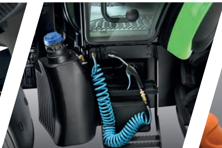
> Connessioni per gli accessori ad aria compressa all'esterno e in cabina.
