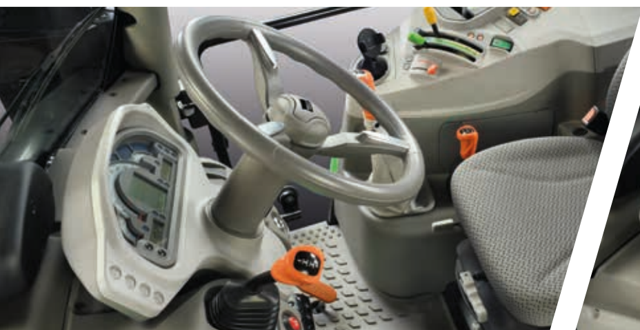
> Inversore meccanico con leva ergonomica su piantone sterzo.
