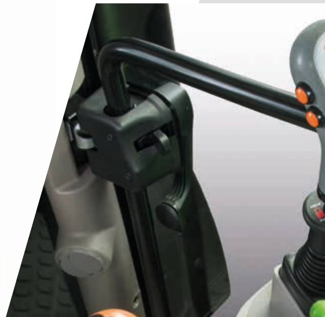
> Joystick con controllo Powershift per un agevole utilizzo del caricatore frontale.
