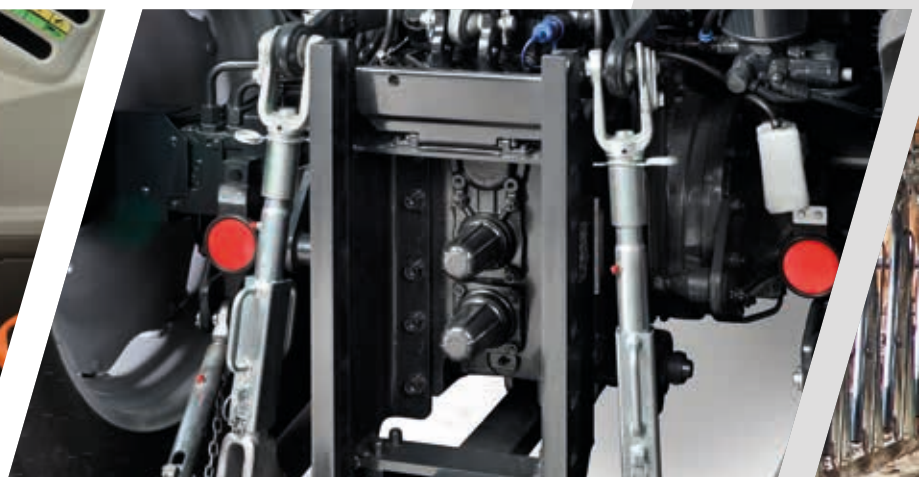
> PTO sincronizzata con albero indipendente.
