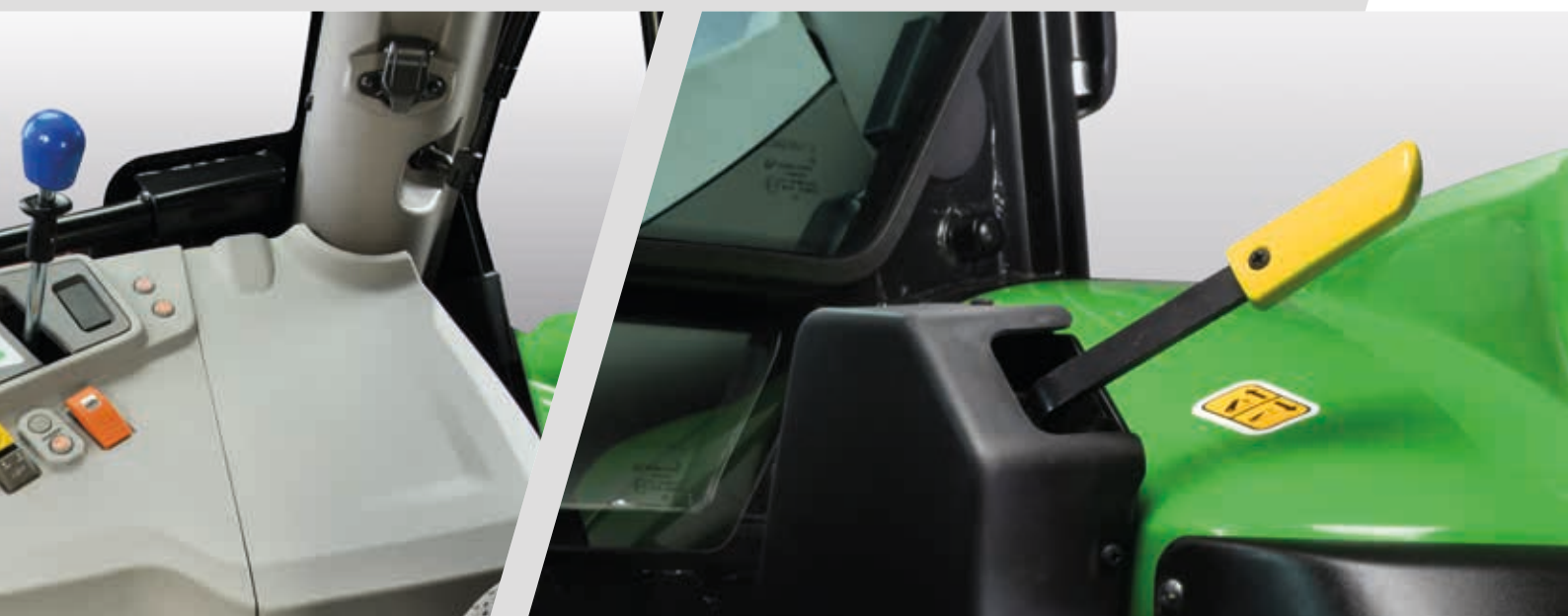
> Comando esterno sollevatore posteriore.
